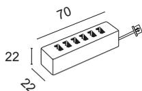
Box obbligatorio per la connessione dei Microspot SKY RGB, ALGOL RGB e HALLEY RGB. Sullo stesso box si possono connettere da uno a sei Microspot. Il box è dotato di connettore per moltiplicatore.
